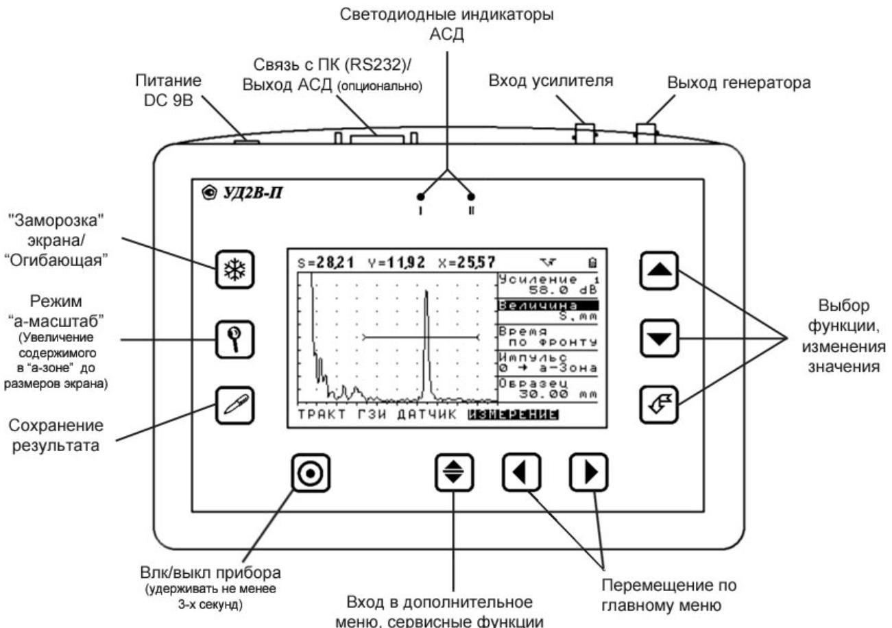
Рис 1-2—Клавиатура дефектоскопа
