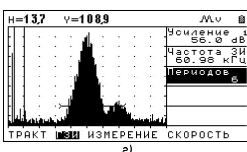
Рис.2-4 Теневой режим, Преобразователи 60кГц а) 1 период ЗИ; б) 2 периода; в) 4 периода; г) 6 периодов
