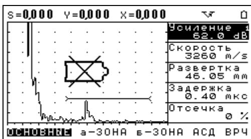
Дефектоскоп автоматически выключится через две минуты после появления символа разрядки. При этом все параметры настройки будут сохранены и восстановятся при следующем включении. На приборах с электролюминесцентным дисплеем (ЭЛД) при этом экран может погаснуть раньше и начать мигать до отключения самого прибора. Это является нормальным эффектом, обусловленным большим энергопотреблением экрана и не влияет на сохранность настроек.
