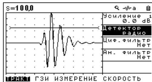
Рис.2-6 Радиочастотный сигнал
