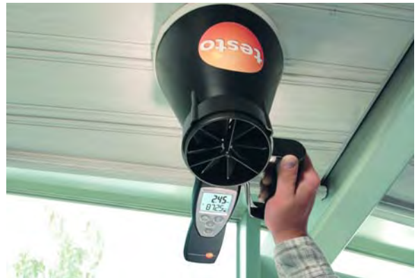
testo 417, используется, например, для мониторинга притока воздуха в потолочных диффузорах и тарельчатых клапанах
