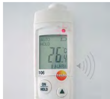
Акустический и оптический сигнал тревоги (LED мигает)
