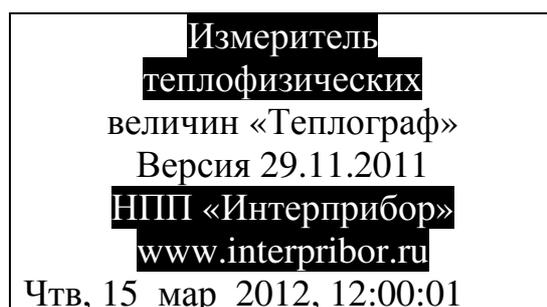
При нажатии клавиши **(M)** на дисплее появится информация о цифровом идентификаторе программного обеспечения Теплографа (контрольная сумма исполняемого кода).
