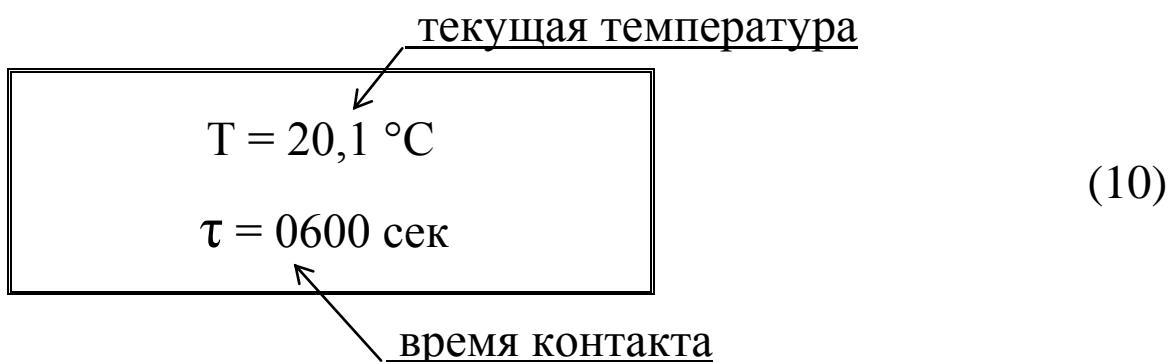
Микрохолодильник начинает охлаждение контактной пластины БХ до заданной температуры с выводом ее текущего значения на дисплей.
