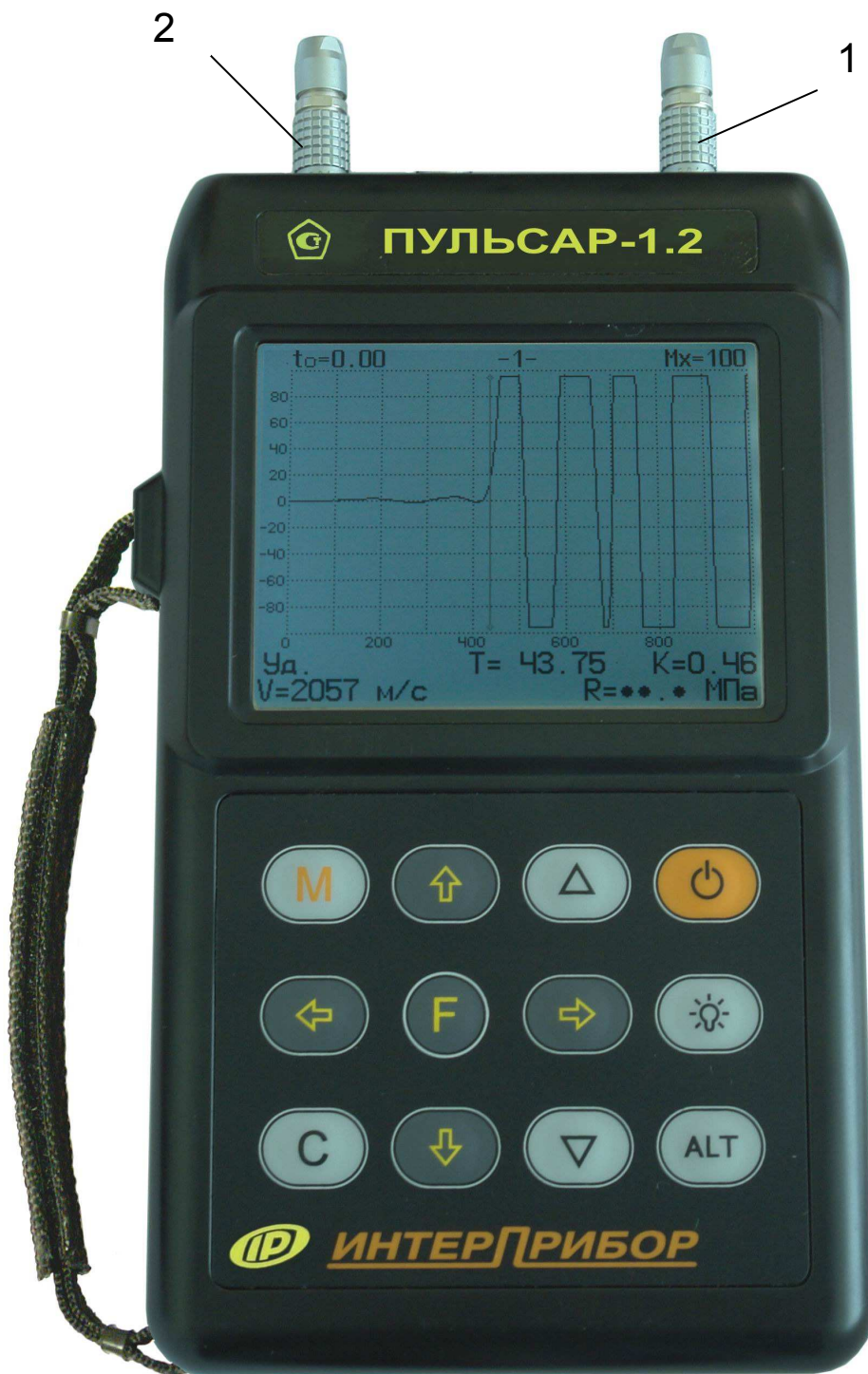
Рис. 3.2. Внешний вид прибора Пульсар-1.2: 1 - вход приемника; 2 – выход излучателя,
