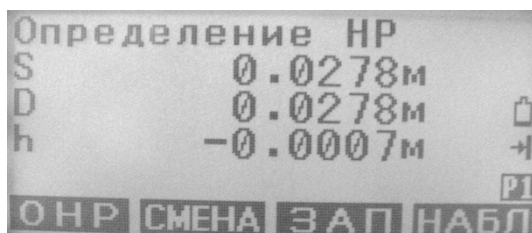
Рис. 52 – Результат определения недоступного расстояния
