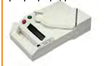
Растворимые соли на поверхности поглощаются специальной фильтровальной бумагой, смоченной в дистиллированной воде. После замера удельного сопротивления влажной бумаги прибор вычисляет и отображает уровень наличия соли в мкг/см<sup>2</sup>.
