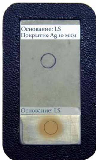
Образец электропроводящего неферромагнитного покрытия на образцовом основании (серебро толщиной h_{\max} - 10 мкм)
