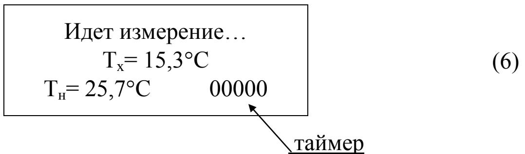
2.4.7 В дальнейшем управляя нагревателем и холодильником программное устройство прибора устанавливает на поверхностях образца заданные температуры  $T_h$  и  $T_x$ , и поддерживает их с точностью  $\pm 0,2$  °C до тех пор, пока тепловой поток, проходящий через измеряемый образец, не стабилизируется.
