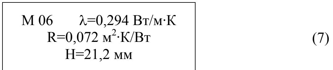
2.4.9 Для повторного измерения образца необходимо нажатием кнопки **РЕЖИМ** перевести прибор в экран (1) и выполнить операции по п.п.2.4.2...2.4.6 РЭ. Значения  $H$ ,  $T_x$  и  $T_h$ , установленные ранее, сохраняются в памяти прибора.
