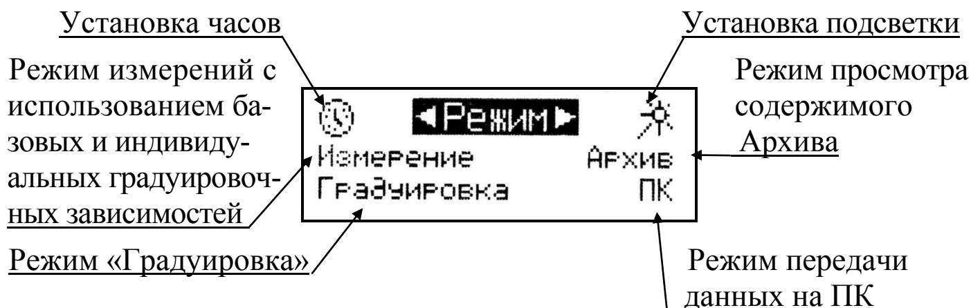
Вид экрана «Режим» измерителя ИПА-МГ4:
