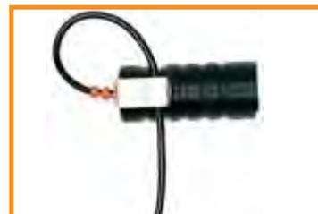
**АДАПТЕР V-ФОРМЫ** идеально подходит для точного размещения датчиков на искривленных поверхностях большого диаметра, таких как трубы и цилиндры. Необходимо лишь вставить датчик в адаптер и приступить к выполнению измерений.
