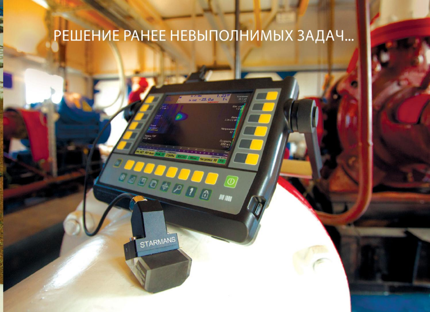
Ультразвуковой дефектоскоп DIO 1000 PA — высокочастотный дефектоскоп премиум класса, сочетающий в себе как традиционный метод выявления дефектов, так и новейшие технологии контроля: контроль с помощью фазированных решеток, ЭМА (бесконтактный метод) и TOFD, с возможностью подключения соответствующих преобразователей и сканеров.
