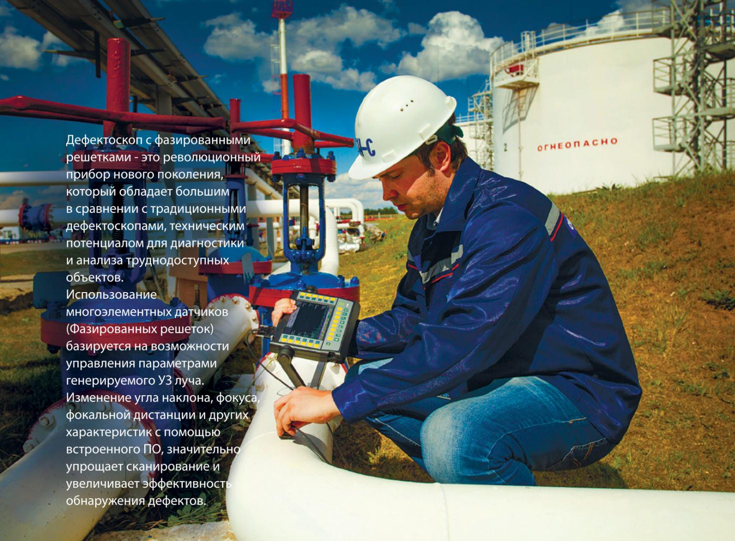
Дефектоскоп с фазированными решетками - это революционный прибор нового поколения, который обладает большим потенциалом для диагностики и анализа труднодоступных объектов. Использование многоэлементных датчиков (Фазированных решеток) базируется на возможности управления параметрами генерируемого УЗ луча. Изменение угла наклона, фокуса, фокальной дистанции и других характеристик с помощью встроенного ПО, значительно упрощает сканирование и увеличивает эффективность обнаружения дефектов.
