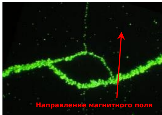
Индикация трещин методом флуоресцентного МК
