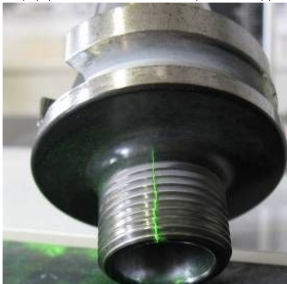
Индикация трещины, полученная при использовании водной суспензии на основе концентрата Super Magna LY 1500-MP
